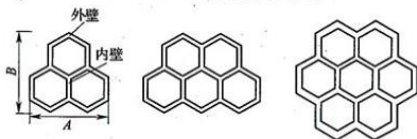
图6 蜂窝式塑料管横断面形式
